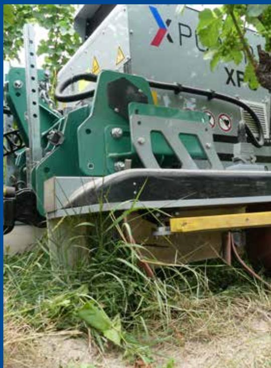
En tant que **solution arrière**, le XPS est monté sur un châssis à largeur réglable hydrauliquement.
