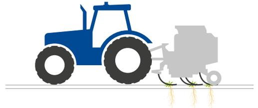
La bonne quantité d'énergie ainsi qu'un applicateur optimisé sont déterminants pour l'efficacité. Les plantes à forte teneur en eau et avec peu de tiges et de racines par rapport à leur surface foliaire nécessitent peu d'énergie et sont faciles à traiter.
