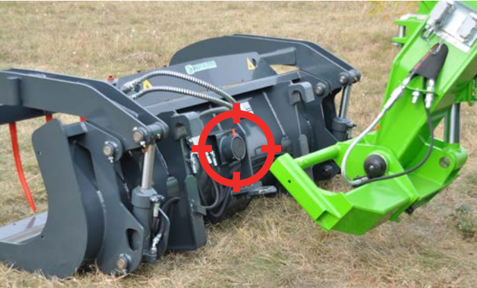
Am Anbaugerät installierter Sensor
