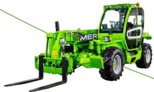
Teleskoplader mit Abstützungen
