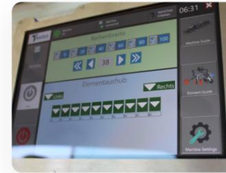
Bei hydraulischen Elementen wird auch automatisch unser Terminal SM-Control mitgeliefert. Diese Bedienung bietet die Möglichkeit die hydraulischen Bandbreitenverstellung und Einzelaushub zu bedienen. Informationen über sämtliche Einstellmöglichkeiten sowie das Benutzerhandbuch sind im Terminal integriert. Ebenfalls können über das neue Terminal Fernwartungen und Updates durch das Samo-Service-Team durchgeführt werden.
