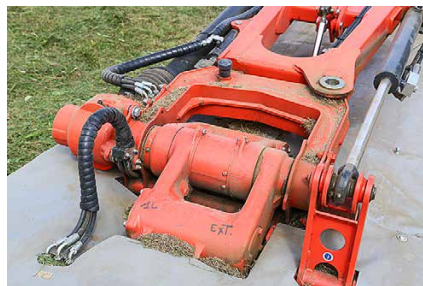
Das speziell konstruierte Getriebe ist das Herzstück des GMD 15030.
