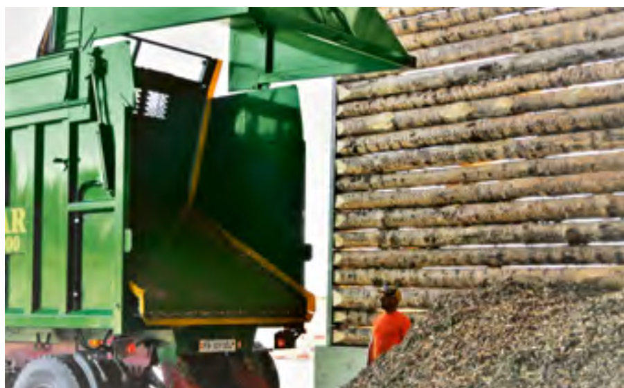
Während der Entlade-Schlussphase heben und schwenken zwei vertikale Hydraulikzylinder die verschobene Wand, um die Holzschnitzelreste sauber auszuladen.
