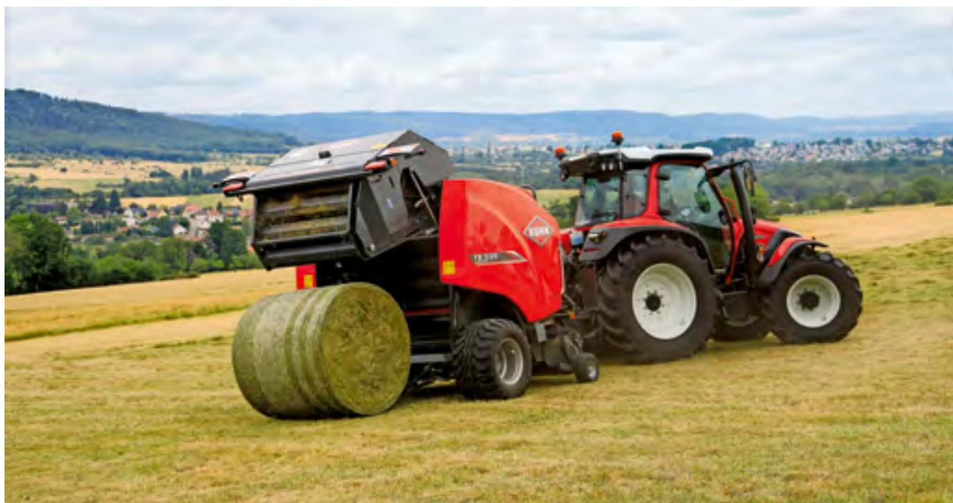
Avec la presse à balles rondes à chambre fixe «FB 3125», Kuhn lance un modèle relativement simple sur le marché, formant les balles avec 18 rouleaux de compression profilés. Photo: Johannes Paar
