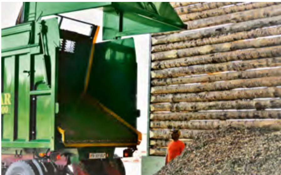
Lors de la phase ultime du déchargement, deux vérins verticaux soulèvent et pivotent la paroi translative pour décharger les résidus de plaquettes.
